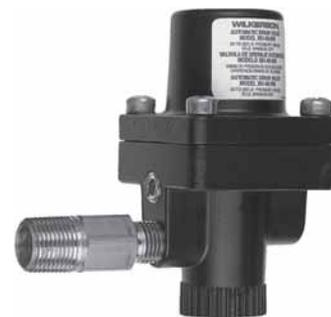
Purga agua líquida y aceite automáticamente del sistema y depósitos de aire comprimido. Esta válvula de purga se abre automáticamente cada vez que la presión del sistema baja aproximadamente 10 PSI durante el ciclo de compresor. El diseño interno del pistón, el cual no utiliza flotadores, minimiza los riesgos asociados con fallas de purga.
